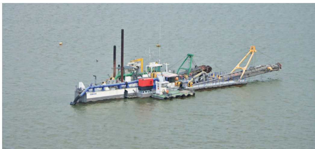
PERAWATAN: Kapal mengeruk sedimentasi di Waduk Gajah Mungkur agar mampu menampung air lebih optimal.
